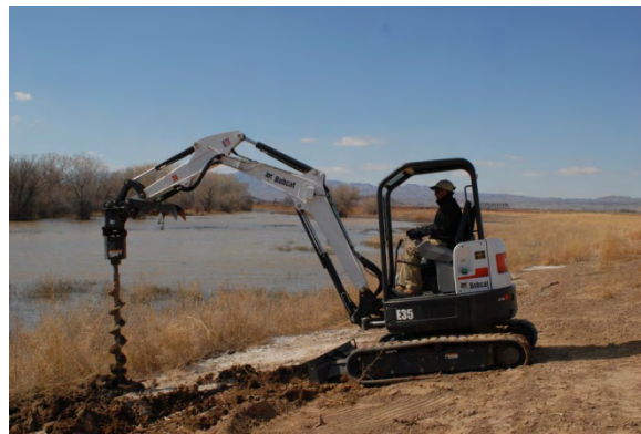
Bobcat E35 Mini Excavator removing Salt cedar & planting Black willows
